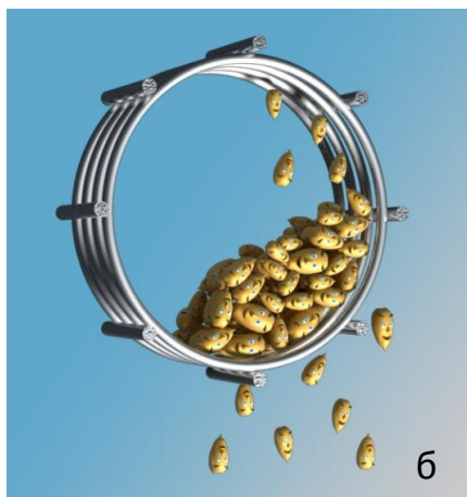
Рис. 11. Схема взаимодействия зерна в решетках барабанного типа: а – решето из тонкого листа, б – рельефное решето Фадеева.
