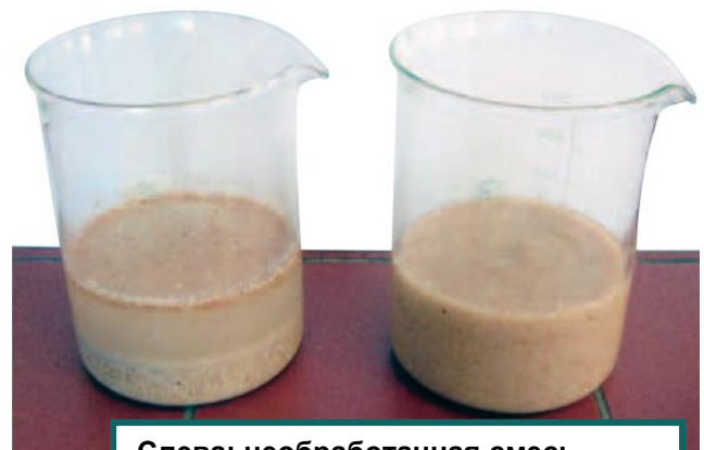
Слева: необработанная смесь зерновых в воде. Справа: экструдированная смесь
