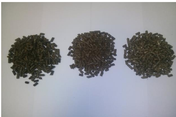
На фото гранулы побочного продукта из подсолнечника в смеси с зерновой группой слева направо в пропорции 70:30; 50:50; 30:70
