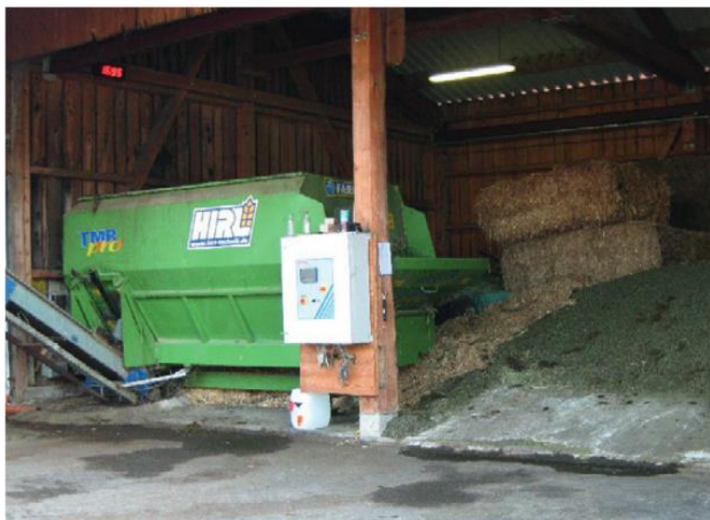
Рисунок 3. Слева: стационарный миксер с управлением; справа: транспортер с кормом над кормовым столом
