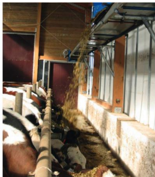
Рисунок 3. Слева: стационарный миксер с управлением; справа: транспортер с кормом над кормовым столом
