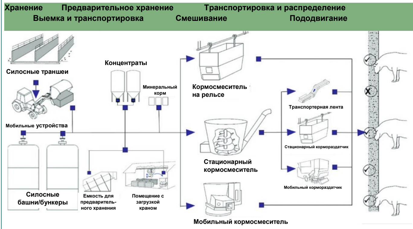
Рисунок 1: Технологии в производственной цепочке для реализации различных ступеней автоматизации кормления (Хайдн и др., 2013)
