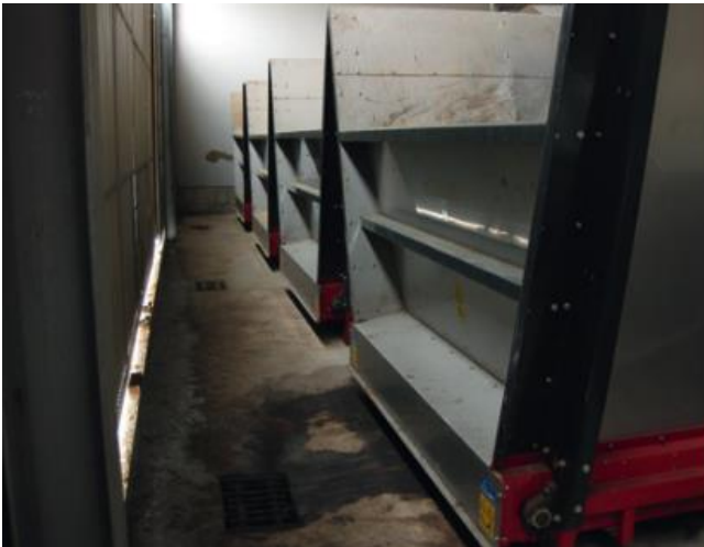
Рисунок 9. Слева: отвод технической воды и бродильных соков; справа: остатки корма под оборудованием (источник: Оберщецл)
