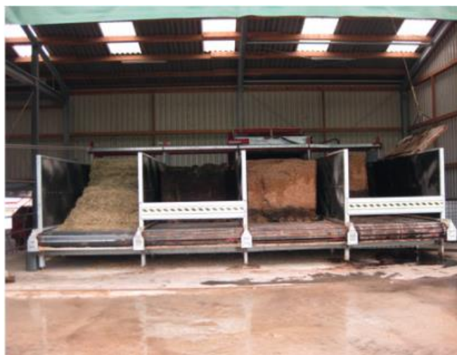
Рисунок 8. Слева: косое размещение бункера предварительного хранения; справа: горизонтальное размещение
