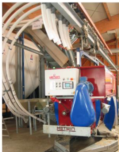
Рисунок 4. Слева: бункер для предварительного хранения; по середине: рельсовый кормосмеситель и кормораздатчик; справа: стационарный миксер и кормораздатчик на рельсах (источник: Обершецл)
