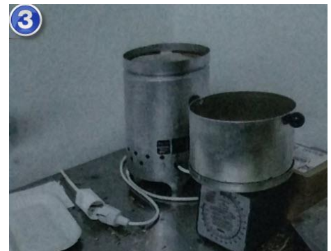
Koster-Moisture-Tester состоит из модуля нагрева и вентилятора
