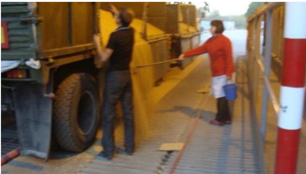
Фото 4. Відбір проби у потоці при вивантаженні автомобіля.
